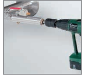
CS delme tertibatı ile basınç altında delme
