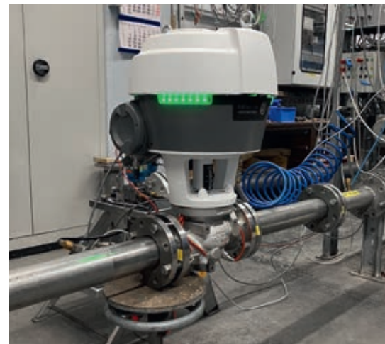
FOCUS-1: Akış ve merkezi olmayan proses kontrolü için akıllı ölçer vanası
